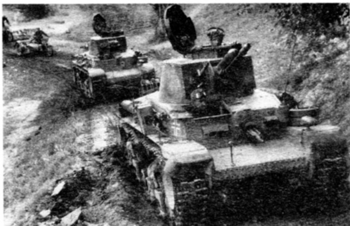
Колонна Pz.35(t). Восточный фронт, лето 1941 года. На левых надгусеничных полках машин хорошо видны светомаскировочные фары Notek и запасные опорные катки, появившиеся перед Французской кампанией.
