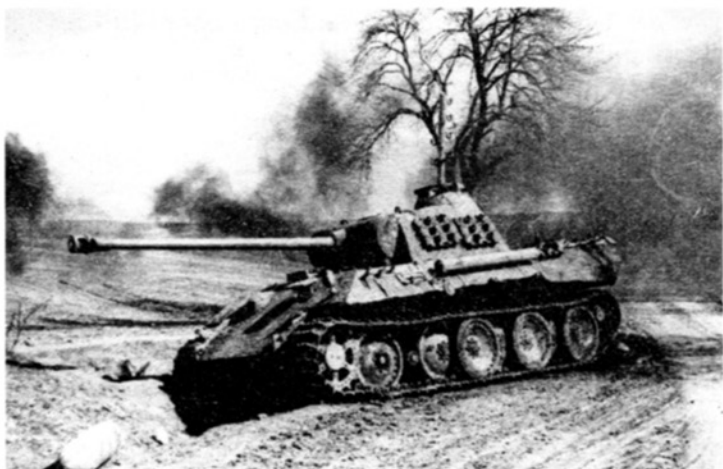
Подбитая «Пантера» модели А. У танка отсутствует первый опорный каток из наружного ряда. Навешивание на борта башни запасных траков для дополнительной защиты было обычным явлением. 1-й Украинский фронт, 1944 год.
