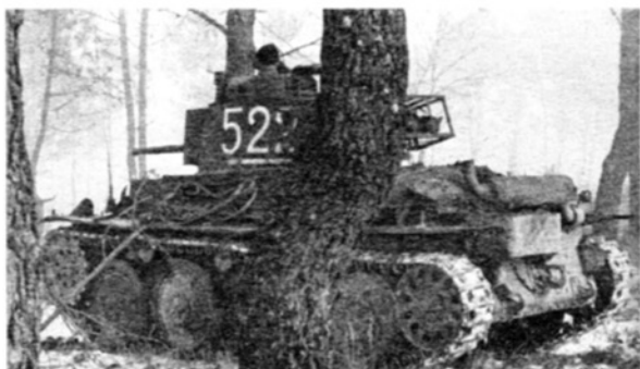
Pz.38(t) Ausf.G из 22-й танковой дивизии. Осень 1942 года. Обращает на себя внимание нештатный ящик для снаряжения на корме башни.
