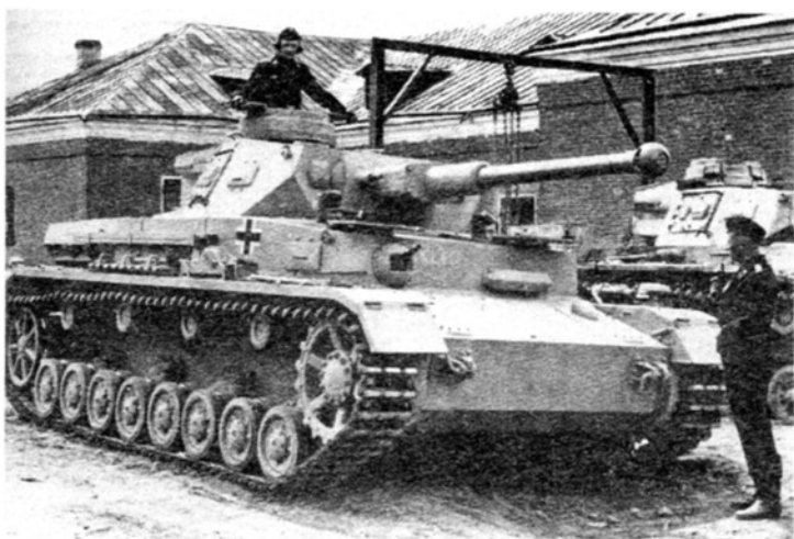
Средний танк Pz.IV Ausf.F2. Судя по наличию смотровых приборов заряжающего на лобовом и правом бортовом листах башни, эта машина переоборудована из танка модификации F1.
