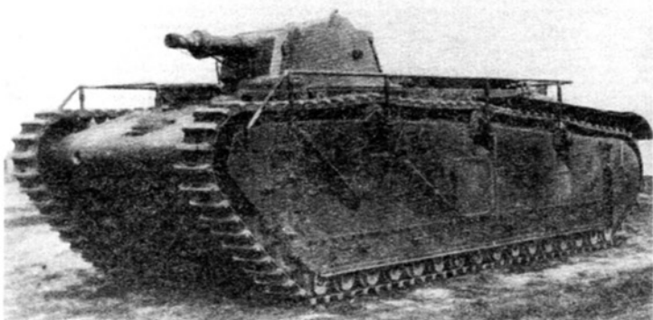
Первенец германского танкостроения – тяжелый танк Grosstraktor («большой трактор»). В июле 1929 года две такие машины проходили испытания на советско-германском полигоне «Кама» под Казанью.
