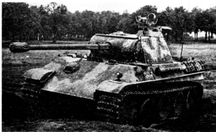
«Пантера» Ausf.G с установленным на командирской башенке прибором ночного видения.
