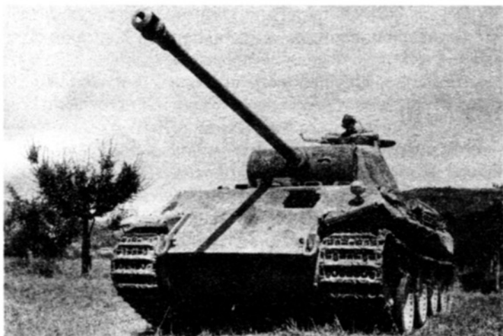
«Пантера» Ausf.D позднего выпуска. Эта машина имеет многие черты, характерные для Ausf.A, — одну фару на лобовом листе, новую командирскую башенку, отсутствие лючка для выброса стреляных гильз в левом борту башни и т.д.
