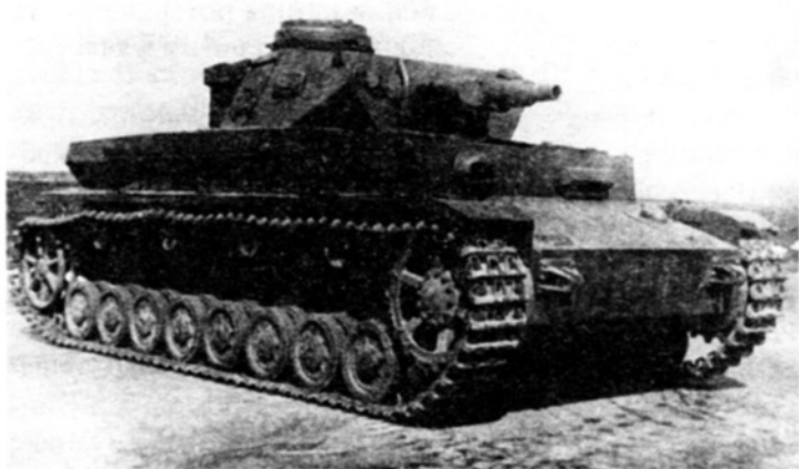
Pz.IV Ausf.F1 на НИИБТПолигоне в Кубинке. 1947 год. Характерная деталь этой модификации — прямая лобовая плита с шаровой установкой курсового пулемета.
