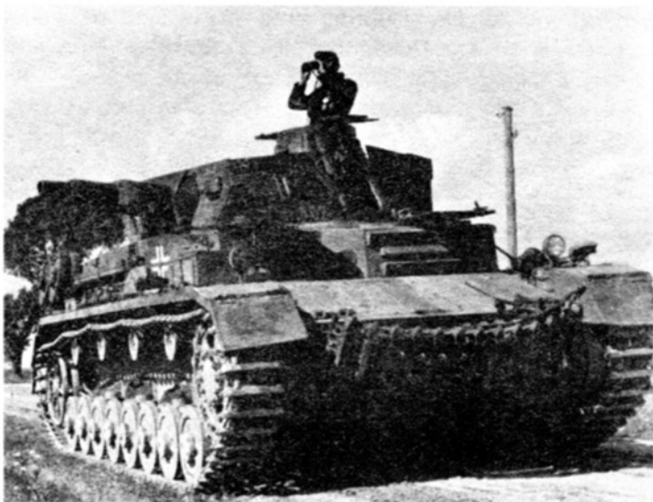
Pz.IV Ausf.D, 6-я танковая дивизия, лето 1941 года. К началу операции «Барбаросса» машины ранних выпусков приобрели черты, характерные для более поздних моделей, — ящик для снаряжения на корме башни и гусеничные траки на лобовой броне корпуса.
