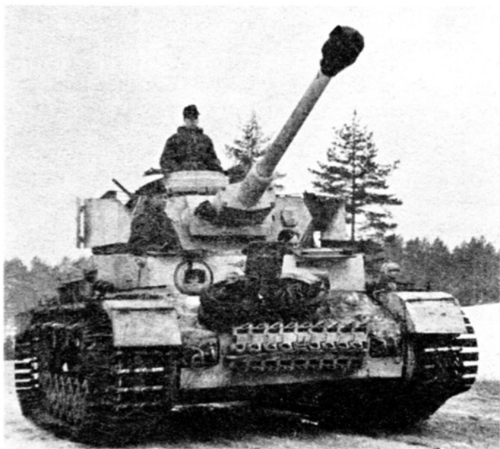
Pz.IV Ausf.G поздних выпусков. Об этом можно судить по приваренной дополнительной лобовой броне, противоккумулятивным экранам и способу крепления запасных траков. Бортные экраны отсутствуют по причине установки «восточных гусениц» с насадками-уширителями. Восточный фронт, зима 1943/44 года.
