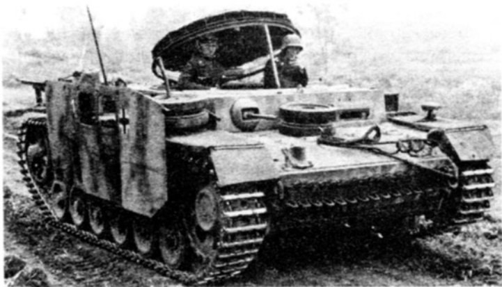
После демонтажа башни часть танков переоборудовали в подвозчики боеприпасов Munitionsschlepper III.
