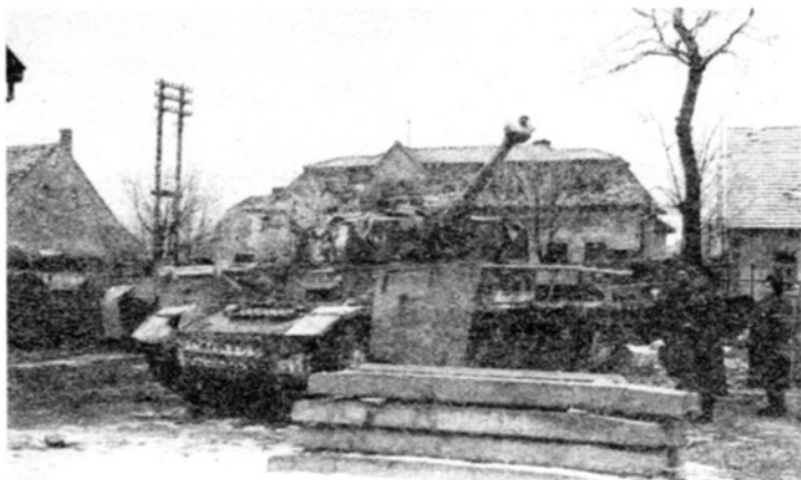
Pz.IV Ausf.J, захваченный в г. Тага. Венгрия, март 1945 года. На машине установлены сетчатые бортовые экраны «типа Тома».
