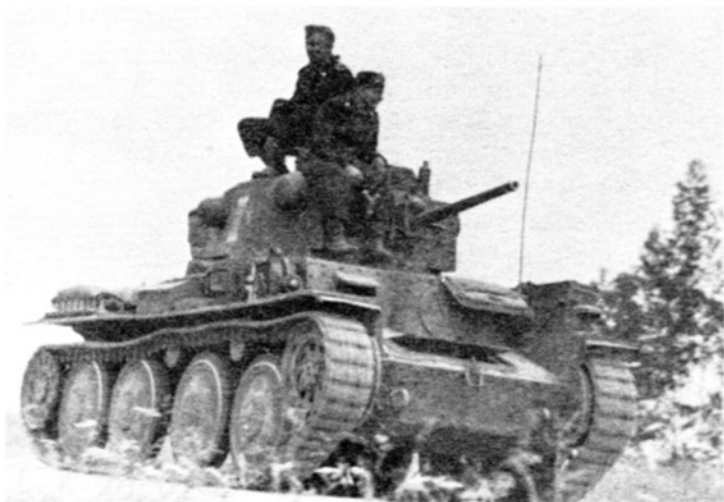
Pz.38(t) Ausf.B из состава 9-й танковой дивизии Вермахта. Восточный фронт, лето 1941 года. Судя по отсутствию курсового пулемета, это командирская машина.
