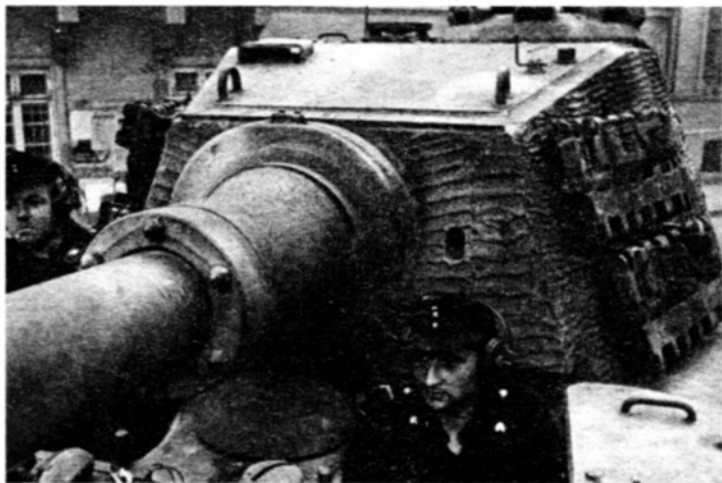
Башня «Королевского тигра» крупным планом. 88-мм пушка L/71 — без сомнения, лучшая танковая пушка периода Второй мировой войны.
