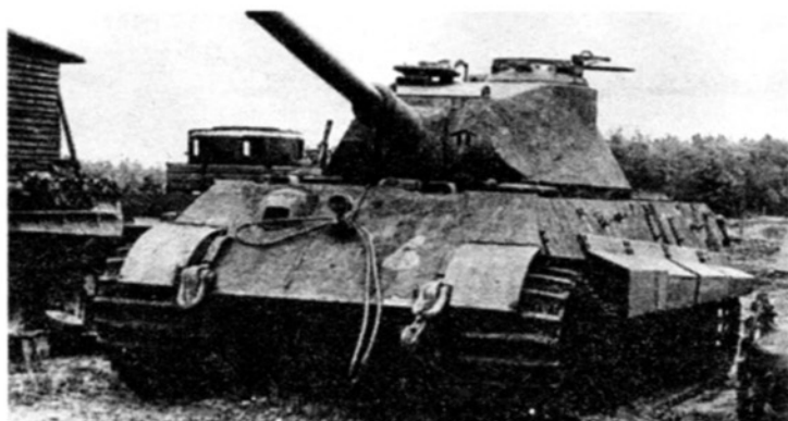
Захваченный союзниками «Королевский тигр» раннего выпуска, покрытый циммеритом.
