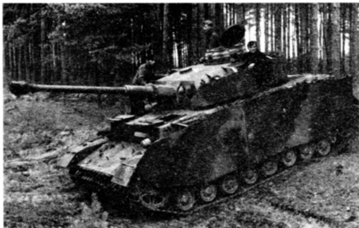
Pz.IV Ausf.J ранних выпусков. Почти полное внешнее соответствие модификации Н (единственное отличие — отсутствие бортового прибора наблюдения механика-водителя). Восточный фронт, 1944 год.
