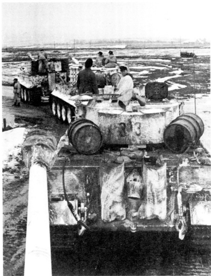
Колонна «тигров» 505-го тяжелого танкового батальона. Восточный фронт, весна 1944 года. Налицо стремление экипажей увеличить возимый запас топлива, хотя бы и за счет размещения на крыше МТО бочек с бензином.
