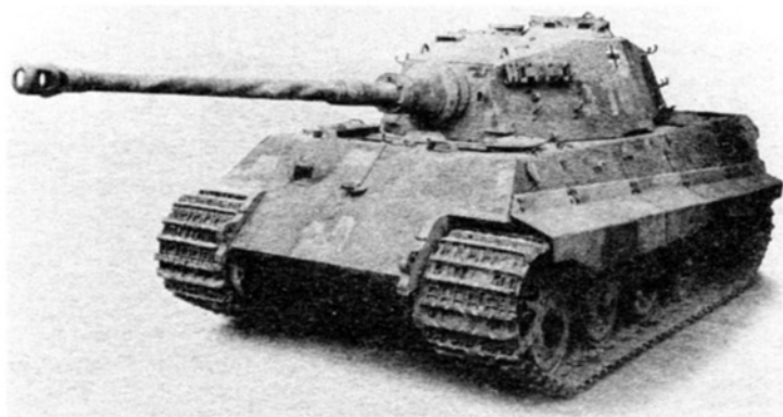
Большая часть из 489 изготовленных «королевских тигров» оснащалась башнями фирмы «Хеншель».
