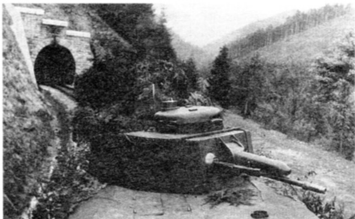
Некоторое количество башен, снятых с неисправных или переоборудованных танков Pz.35(t), использовалось на бронепоездах.
