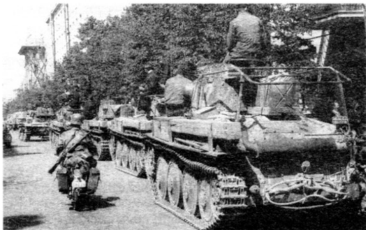
Танки Pz.38(t) 8-й танковой дивизии на одной из улиц Парижа. Июнь 1940 года. На переднем плане командирский танк, оснащенный рамочной антенной.
