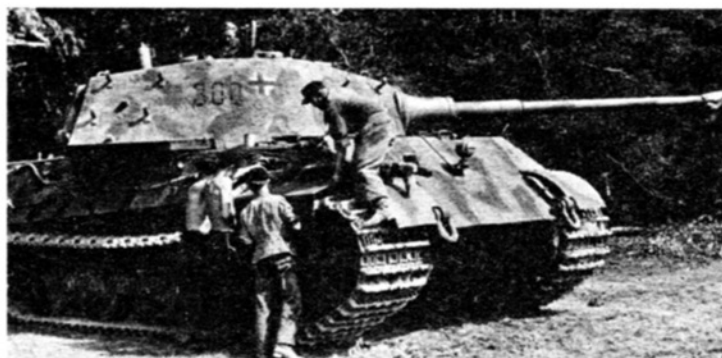
В сентябре 1944 года в 503-й тяжелый танковый батальон поступили первые «королевские тигры» с башнями «типа Хеншель».
