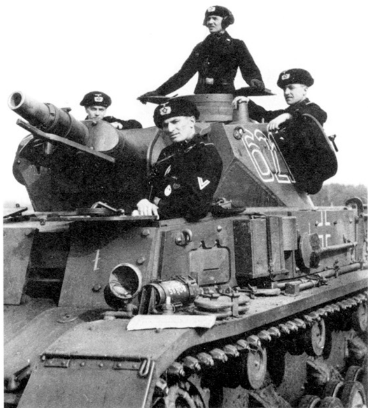
Pz.IV Ausf.D 19-й танковой дивизии, осень 1940 года. На лобовом и бортовом листах корпуса хорошо видно дополнительное бронирование.
